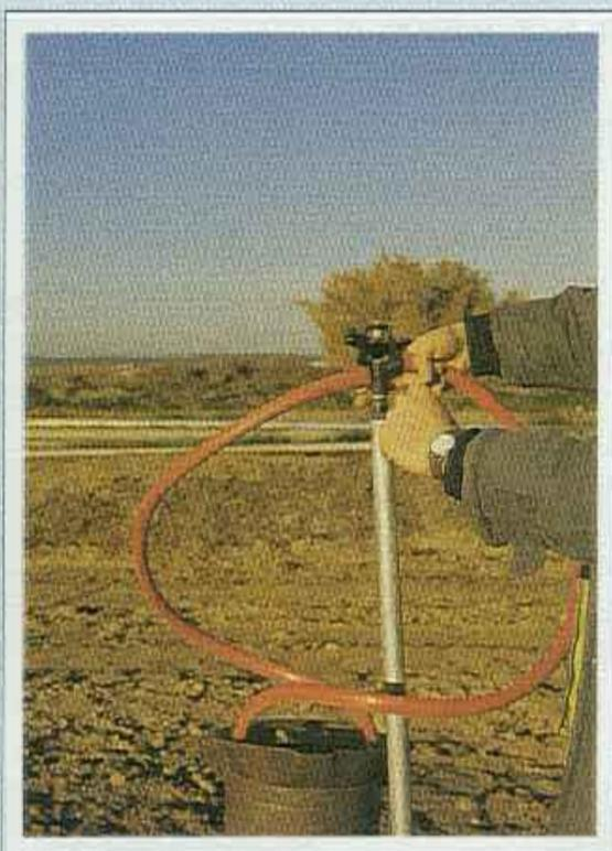
*Método directo de medida de caudal en un aspersor con un reloj y un recipiente de volumen conocido. Los dos tramos de manguera recogen el agua que sale de las boquillas del aspersor.*
