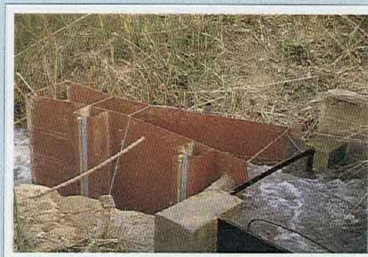
*Medidor Parshall instalado en la entrada de agua a una parcela.*
