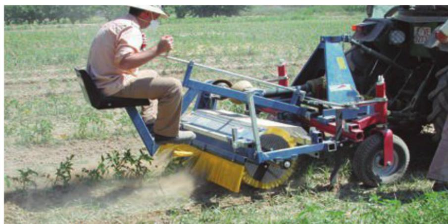
**Cepillo de eje horizontal utilizado en tomate de industria. Se observa un protector para el cultivo. El apero dispone de un asiento para dirigirlo manualmente y evitar dañar el cultivo.**
